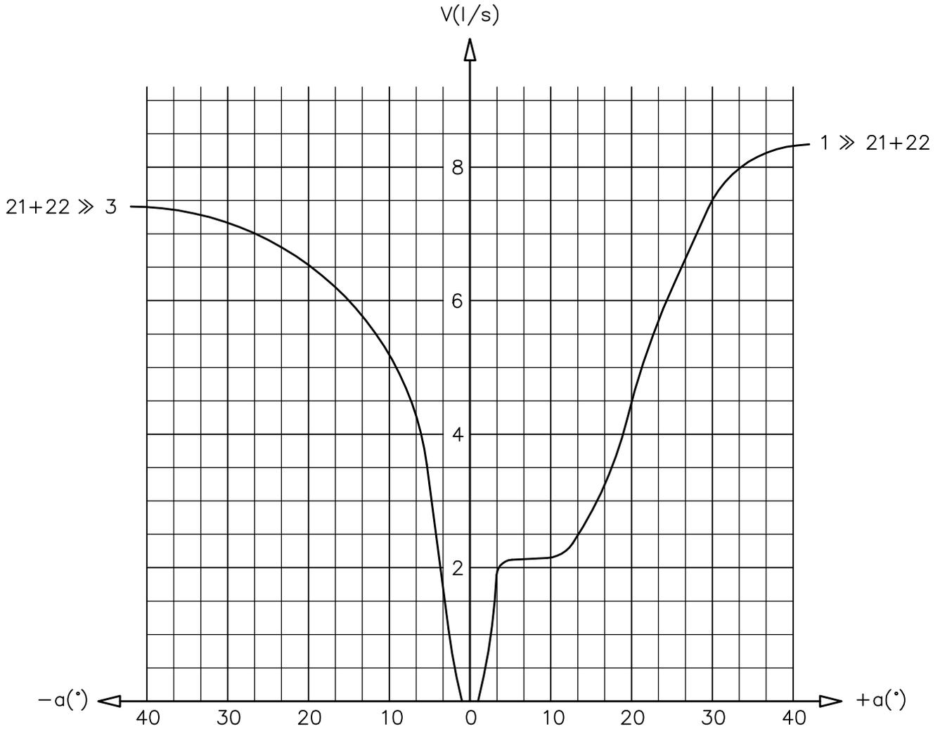
$V$  = Caudal de aire atmosférico desde la conexión 1 hasta las conexiones 21+22 o desde las conexiones 21+22 hasta el escape 3, a una presión de entrada de 6 bar.
